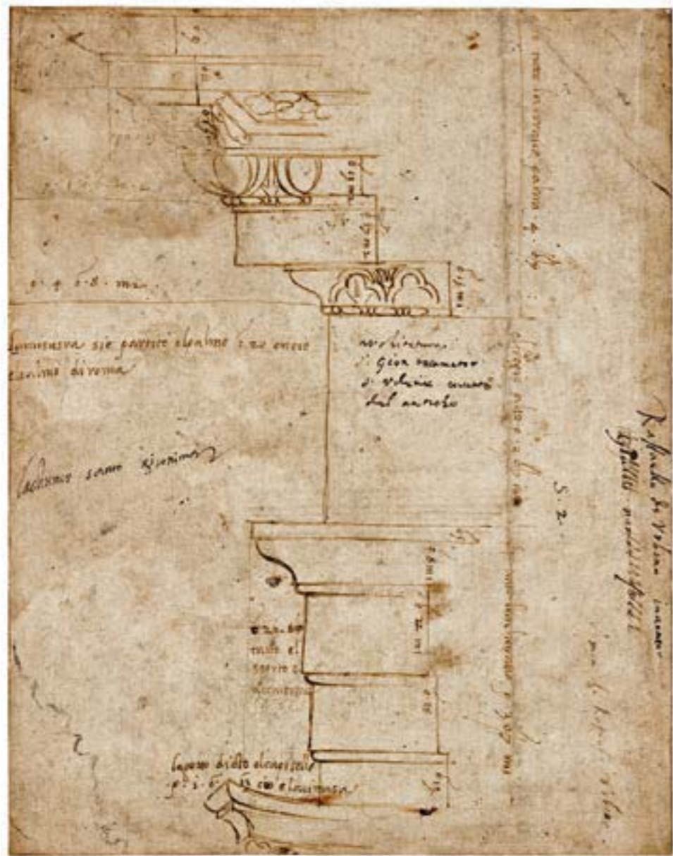
10/ Raffaello, particolare della trabeazione dell'ordine inferiore all'interno del Pantheon (Londra, R.I.B.A., XIII/tr). Ripr. per concessione del R.I.B.A. n. 19057 del 2.XI.2022.
