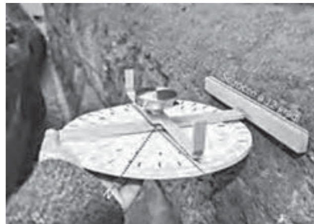
3/ Ricostruzione della bussola da rilievo con la calamita (da C. MODONUTTI, Bussola e rilievo architettonico nei disegni di Antonio da Sangallo il Giovane e Baldassarre Peruzzi , in "Annali di architettura", XXVI (2014), pp. 7-28, fig. 32). 3/ Reconstruction of the compass for survey with the magnet (from C. MODONUTTI, Bussola e rilievo architettonico nei disegni di Antonio da Sangallo il Giovane e Baldassarre Peruzzi , in "Annali di architettura", XXVI (2014), pp. 7-28, fig. 32).
